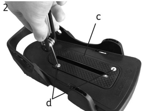
Platzieren Sie die Fußschale so, dass die Befestigungsschraube durch den in der Fußplatte befindlichen Schlitz hindurchgeht. Zur Befestigung legen Sie die Gummischeibe (e) auf die Unterseite der Fußplatte, gefolgt von der Metall-Unterlegscheibe (f). Anschließend setzen Sie den Drehknopf (g) auf die Befestigungsschraube auf. Die Fußschalen positionieren Sie, indem sie den Drehknopf (g) unter der Fußplatte lösen, die gewünschte Position einstellen und ihn wieder festziehen.
